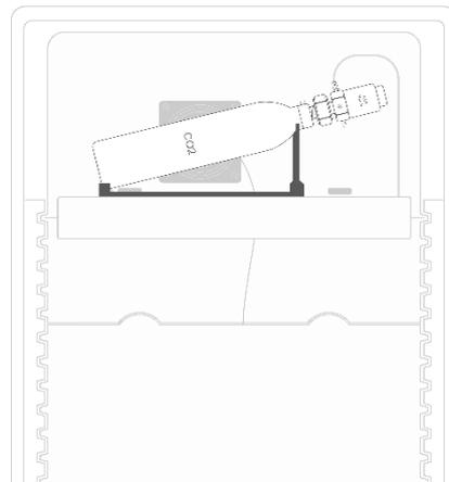
Als nächstes muss die Schraube (Feinnadelventil) am Druckminderer wieder geöffnet werden, sodass CO<sub>2</sub> aus der Flasche strömen kann. Da ohne Strom das CO<sub>2</sub>-Ventil geschlossen ist, sollten Sie keinerlei Zischen hören. Kontrollieren Sie noch einmal alle Schrauben und Verbindungen des CO<sub>2</sub>-Systems und drehen dann 3 mal 360 Grad (also 3 komplette Umdrehungen) die Schraube am Druckminderer auf.
