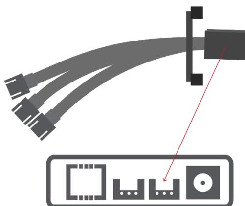
Klippe nun die beiden Haken des Montageplättchens in die Lüfterslitze und verhindere dadurch das Lösen der Steckverbindung durch Zug der Verteilerstränge.
