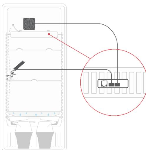
Im nächsten Schritt kann das Sensorkabel (weißes Kabel, welches hinten aus dem Einschub kommt und eine Kunststoffabdeckung am Ende montiert hat) in die Vorrichtung am Lüfter montiert werden.
