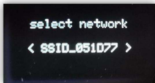
Über den Drehklick-Knopf kann man im nächsten Schritt das Passwort eingeben. Durch langes Drücken des Knopfes kommt man zu den Unterpunkten "Back" und "Done". Stellen Sie sicher, dass eine Verbindung zum Heimnetzwerk möglich ist und ein gutes Signal am FG Modul ankommt.
