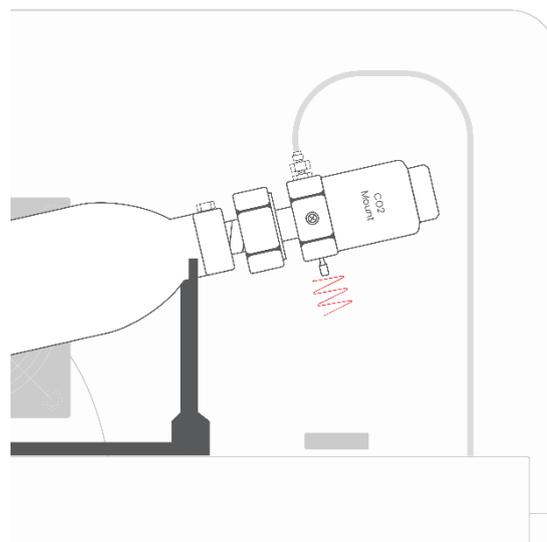
Platzieren Sie die CO<sub>2</sub> Flasche auf dem mitgelieferten Flaschenhalter. Damit ist das CO<sub>2</sub>-System fertig und einsatzbereit. Achten Sie darauf, dass die Flasche und der Flaschenhalter sicher stehen und vor umkippen gesichert sind.
