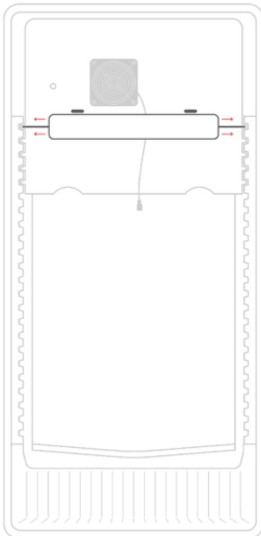
Die Stangen müssen vollständig die Innenwände berühren, sodass ein Verrutschen vermieden wird. Wenn das Modul einen guten Halt hat, drehen Sie die Schrauben an der Oberseite wieder zu.
