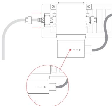
**ACHTUNG: Achten Sie auf die Pfeilrichtung.** Der Schlauch wird auf die Seite angebracht, wo der Pfeil weg geht, sprich an der Seite ohne den Pfeilkopf. Schieben Sie den Schlauch auf das CO2-Ventil, schieben Sie danach die Schraube nach vorne zum Gewinde und schrauben diese gut fest. Die zweite Seite, sprich die Auslasseite, braucht keinen Schlauch.
