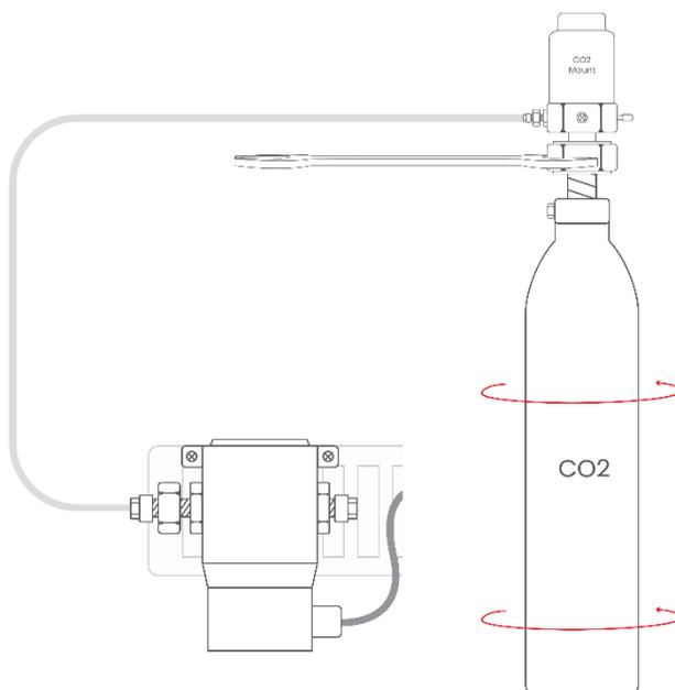
Man hört unter Umständen und kurzes Zischen. Sollte das Zischen dauerhaft sein, muss die Flasche noch weiter hineingedreht werden. Platzieren Sie die CO<sub>2</sub>-Flasche in der Halterung und stellen Sie diese auf den Einschub. Sollte trotz festsitzender Flasche ein lautes Zischen zu hören sein, schrauben Sie umgehend die Flasche wieder heraus und kontaktieren Sie den Support.
