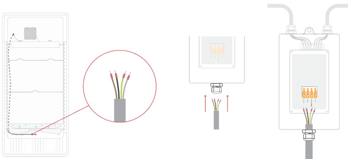
Wenn das Kabel hindurchgesteckt wurde, erkennen Sie eine Klemmleiste mit beschrifteten Eingängen. Stecken Sie die Farben entsprechend der Beschriftung in die dafür vorgesehenen Löcher der Klemme.
